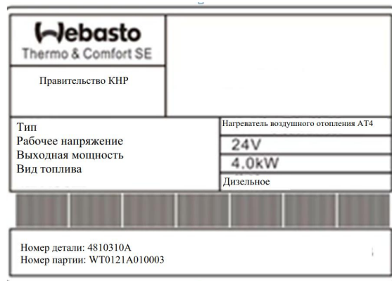
Рис. 4. Паспортная табличка главного механизма (пример)
