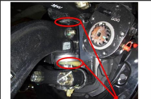
Разлив смазки в двух местах указывают на полное заполнение
